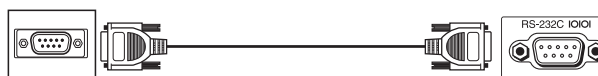
Cable de control en serie RS-232C (tipo cruzado) (de venta en el comercio)
